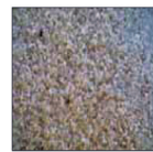
Filtreační písek 0,6–1,2 mm Sand for filtration unit 0,6–1,2 mm
