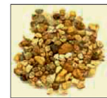
Filtreační písek 1,0–4,0 mm Sand for filtration unit 1,0–4,0 mm
