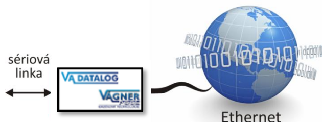
obr. 3 – typické zapojení VA Datalog jako převodníku Ethernetu – sériová linka
